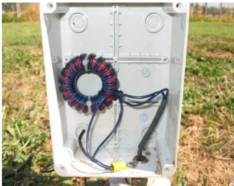
Fissate per finire, la scatola così completata alla base dello stilo in alluminio ed effettuate il collegamento del filo (rosso) proveniente dal toroide, alla base del tubo. Si può fare tutto con viti autofilettanti, ma se volete fare una cosa più pulita e che duri nel tempo forate con una punta di trapano da 8 mm. e mettete degli inserti filettati (da 6 mm.). Bulloncini inox e un bel anello per il collegamento allo stilo e ... il gioco è fatto.
